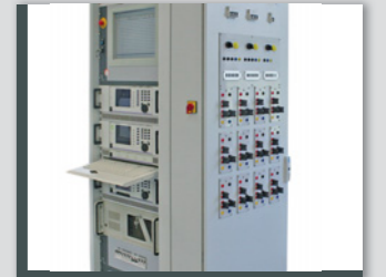
GLP3 Transformatorerwärmungs-Prüfplatz im 19" Schrank mit Leistungsmessern und Anschlussfeld
