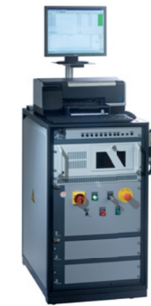
GLP3 im Rollcontainer zur Prüfung von elektromedizinischen Produkten
