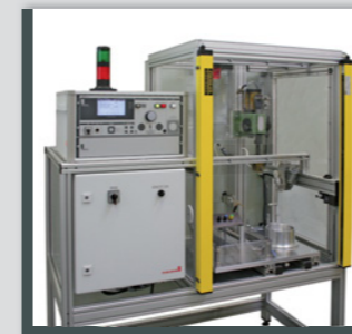
GLP2-e in einer Systemlösung mit Lichtvorhang
