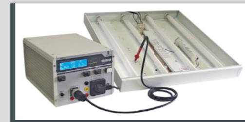
Leuchtenprüfung: PE | Iso | Funktion
