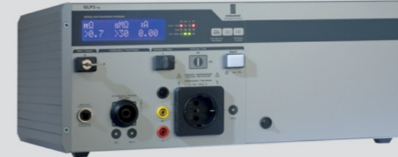
Leuchtenprüfung: PE | Iso | HV | Funktion
