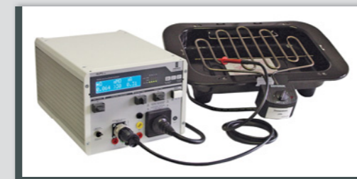
Prüfung eines Elektrogrills: PE | Iso | Funktion
