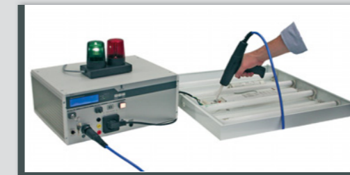
Leuchtenprüfung: PE | Iso | HV | Funktion
